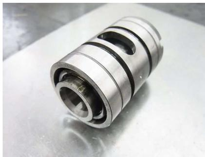
ボールベアリングはフローティングベアリングと違い、回転時に音が出る事が有ります。特にエンジンを切った後でも慣性でしばらくインペラが回る為、音が聞こえることが有ります。
